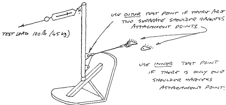
FIG. 2 : SHOULDER HARNESS ANCHORAGE TEST
