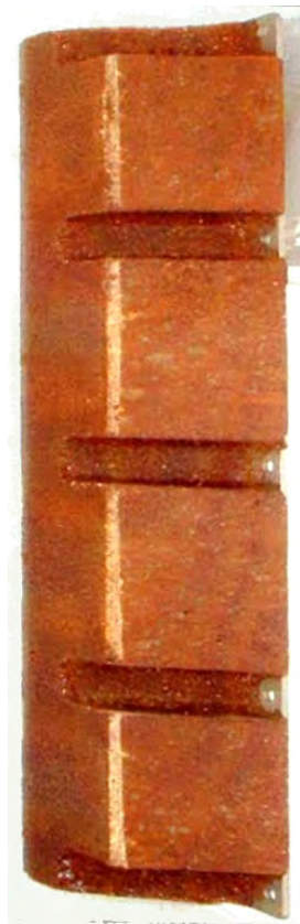
4 CHANNEL RADIATOR SUBARRAY
